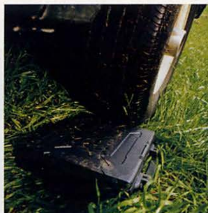
Единственное повреждение, оставшееся у блокнота Panasonic CF-25 после того, как по нему проехал автомобиль, — след от шины
