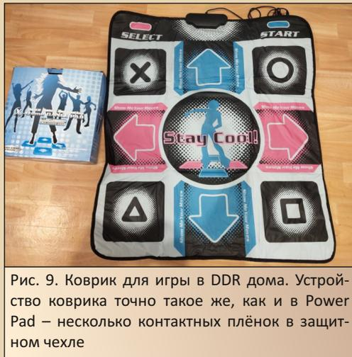
Рис. 9. Коврик для игры в DDR дома. Устройство коврика точно такое же, как и в Power Pad – несколько контактных плёнок в защитном чехле
