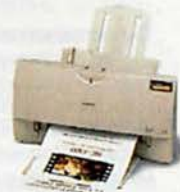
CANON BJC-4300 Цветной принтер формата A4 с дополнительной сканирующей головкой
