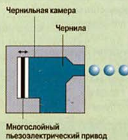
Рис. 2. Пьезоэлектрическая головка фирмы Epson
