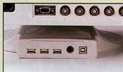
Основание монитора SyncMaster 700Up имеет трехпортовый USB-концентратор с автономным питанием. Удобная управляющая программа максимально упрощает настройку параметров монитора
