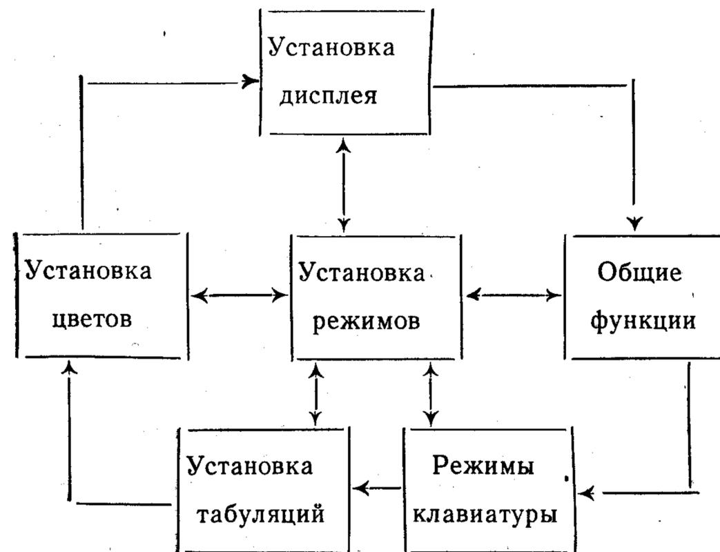
ка режимов» выбрать поле с названием нужной таблицы и нажать клавишу ВВОД. Из любой таблицы, нажав клавишу ВВОД при выбранном поле «В главную таблицу» или «К следующей таблице», можно перейти либо в таблицу «Установка режимов», либо в следующую, согласно приведенной ниже диаграмме.
