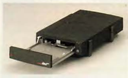
Стример, который не скоро устареет: в лоток накопителя Iomega Ditto Max можно устанавливать картриджи объемом 3, 5 и 7 Гбайт
