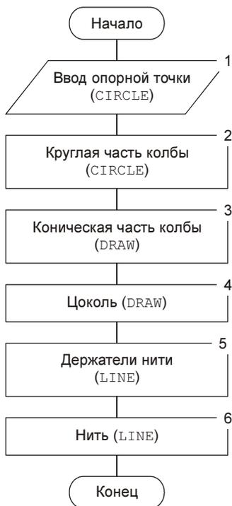
Рис. 8.10. Блок-схема алгоритма рисования лампочки
