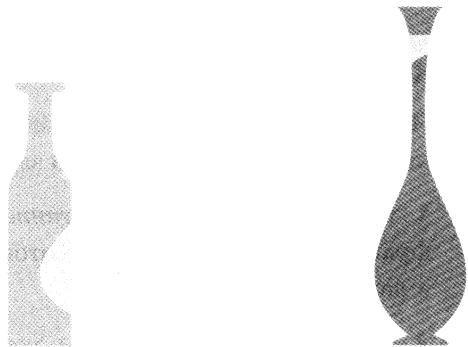
*Инструментом «зеркало» можно создавать симметричные фигуры, а затем соединять их командами **Average** и **Join**.*
