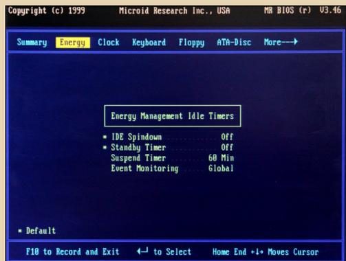
Рис 4. В секции энергосбережения задаются временные параметры
