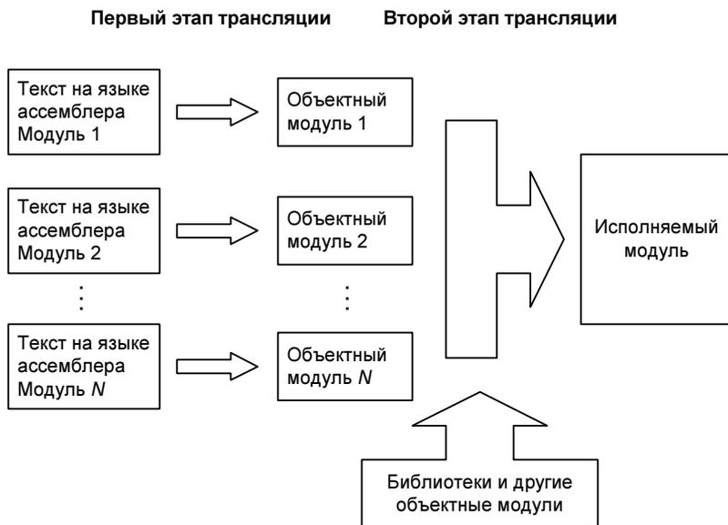
Рис. 1.1.1. Схема трансляции ассемблерного модуля
