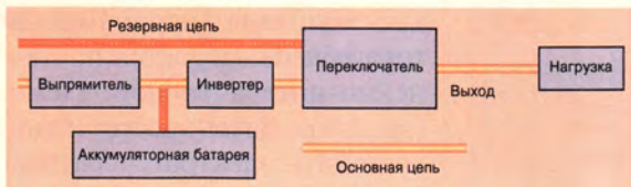
Рис. 2. Постоянно включенный последовательный ИБП с двойным преобразованием.
