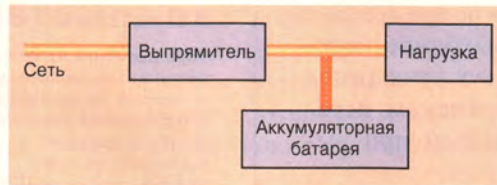
Рис. 5. Параллельный заряжающий ИБП постоянного тока.
