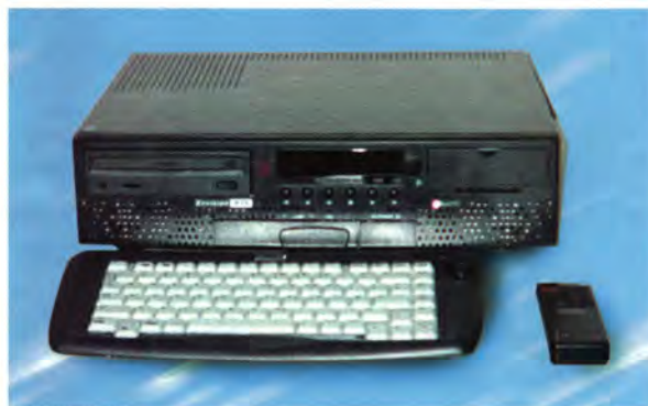
Разработчики Envision использовали стандартные оформление и габариты бытовой радиоаппаратуры
