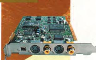
разнообразных проектов. Монтажная плата DV-Raptor компании Canopus позволяет за сравнительно небольшие деньги превратить ПК в полноценный комплекс для ввода, редактирования и вывода видео. Она базируется на оригинальных DV-технологиях компании Canopus, заслуживших признание и высокие оценки профессионалов. DV-Raptor поддерживает режим PCI Bus Master и с помощью программного обеспечения обеспечивает
