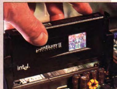
жок. Аккуратно вставьте процессор (убедитесь, что первый контакт процессора совпадает с первым контактом гнезда), плотно прижмите его и опустите рычажок. Если процессор устанавливается в разъем Slot, то внимательно устанавливайте его до тех пор, пока он плотно «не сядет» в разъем.
