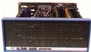
Разработчик Altair — крохотная компания MITS из Альбукерка (шт. Нью-Мексико) — продавала машину в виде комплекта деталей за 397 долл., а полностью собранной — за 498 долл. У Altair был процессор Intel 8080 с тактовой частотой 2 МГц и гигантская оперативная память в 256 байт, а клавиатура и дисплей отсутство-
