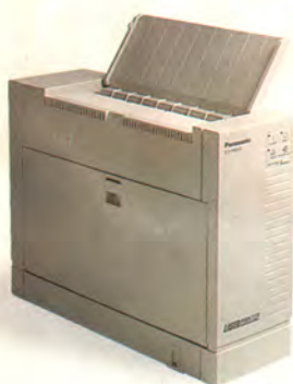
Новый лазерный принтер Panasonic KX-P6500 с разрешением 600 точек на дюйм может отчетливо печатать даже шрифт размером всего 4 пункта
