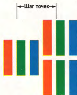
Измерение шага точек у кинескопа со щелевой маской
