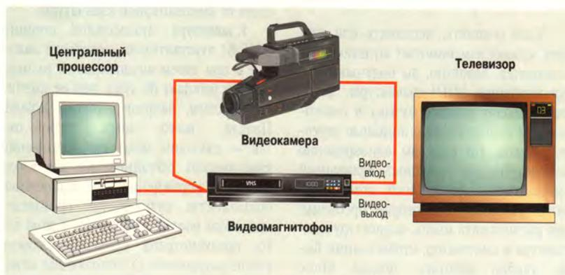
Схема комплекса для видеоредактирования. Залог успеха домашней видеостудии — правильное соединение всех компонентов. Обычно ПК используется для управления редактированием исходной ленты, воспроизводимой на видеомагнитофоне. Видеокамера нужна для просмотра редактируемой ленты, а телевизор — для просмотра результата.
