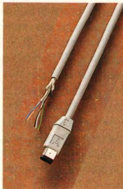
Рис. 3. Первоначальная версия интерфейса FireWire позволяет передавать данные со скоростью 12,5 Мбайт/с.
