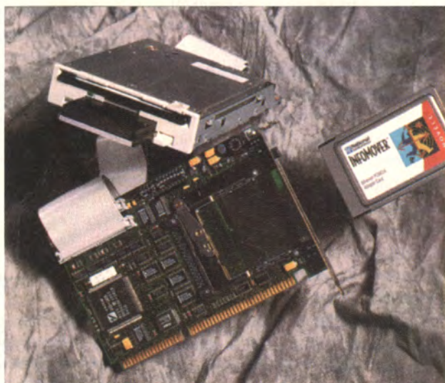
Изделие Premium Combo компании SCM Microsystems дополняет традиционный накопитель на гибких дисках таким редко встречающимся в настольных ПК компонентом, как разъем РСМ-СІА.
