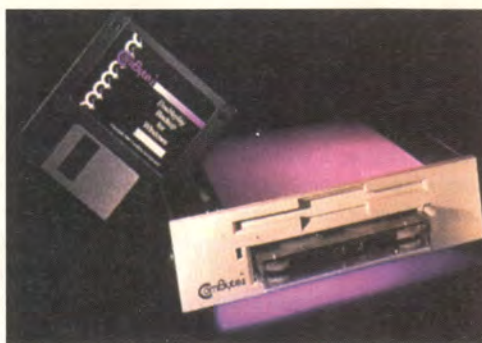
В комбидисководе Doubleplay фирмы ComByte объединены НГМД и стример. Компактность устройства достигается за счет совместного использования компонентов.
