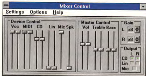
Встроенный в платы Sound Blaster 16 программно-управляемый микшер позволяет смешивать синтезируемые платой звуки с внешними сигналами, поступающими от компакт-диска, линейного входа, микрофона и динамика машины.
