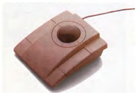
Рис. 2. Шаровой манипулятор фирмы MacAllay обеспечивает разрешение 375 точек на дюйм.
