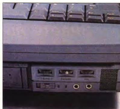
Микширование и регулировку баланса на аппаратном уровне обеспечивает единственный в этом обзоре комплекс — блокнот и установочная станция фирмы Texas Instruments.
