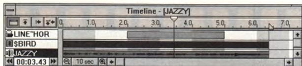
Панель TimeLine позволяет легко решить проблему синхронизации различных объектов, включая и звук.
