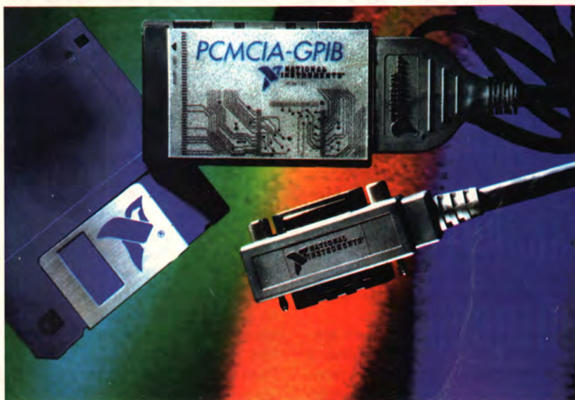
Рис. 1. Карточка преобразователя PCMCIA—GPIB фирмы National Instruments комплектуется программами NI-488.2 для DOS и Windows и двухметровым кабелем со стандартным соединителем.
