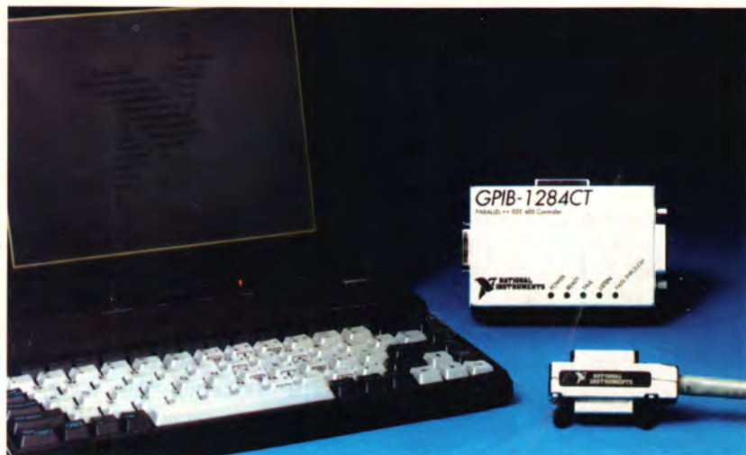
Рис. 2. Даже если в компьютере нет никаких интерфейсов, кроме параллельного порта, к нему можно подключить приборы с интерфейсом GPIB.
