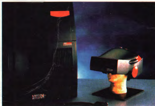
Шлем с полным «погружением» ProVision 100VPX производства компании Division Ltd.
