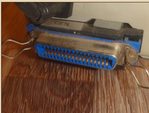
Рис. 3. Разъём интерфейсной вставки – как видите, стандартный 36-контактный, и с ним можно использовать стандартный кабель для порта LPT
