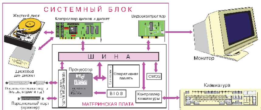
Рис. 2.5. Блок-схема устройства компьютера (стрелками показаны направления передачи данных)
