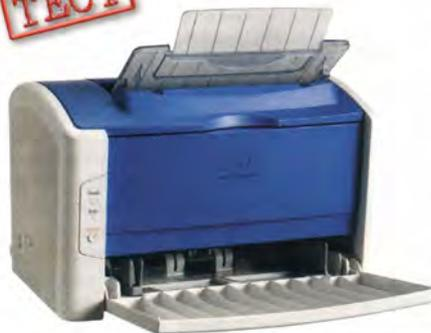
Монохромный лазерный принтер формата А4
