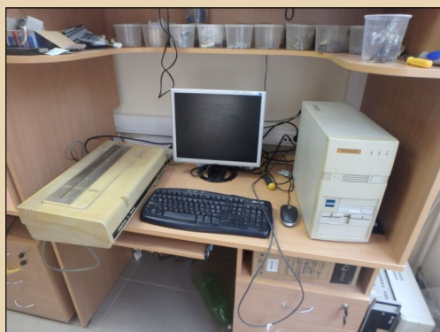
Рис. 8. Robotron K6314 в составе рабочего места
