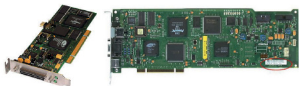
Рисунок 11. SCSI-контроллер с несъемным BIOS (слева), он нам не подходит. Справа SCSI-контроллер со съемным BIOS, который легким движением руки превращается в плату удаленного управления
