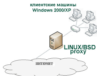
Рисунок 1. Локальная сеть небольшой организации с одним выделенным компьютером-бастионом
