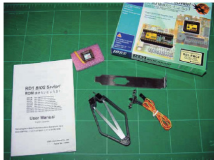
Рисунок 2. Набор BIOS Savior kit для безопасного извлечения микросхемы BIOS с материнской платы и «кроватька» для резервного BIOS с переключателем, устанавливаемым на заднюю панель
