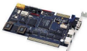
Рисунок 5. Еще одна плата удаленного управления - PC Weasel 2000
