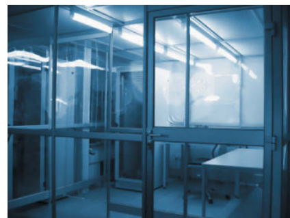
Рисунок 3. Чистая комната, в которой вскрывают гермоблоки жестких дисков
