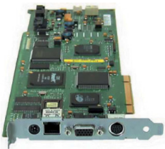
Рисунок 4. Плата удаленного управления Remote Insight on Hewlett-Packard
