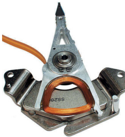
Рисунок 14. Звуковая катушка
