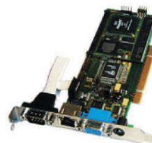
Рисунок 7. Плата удаленного управления типа eRIC enhanced Remote Management Card
