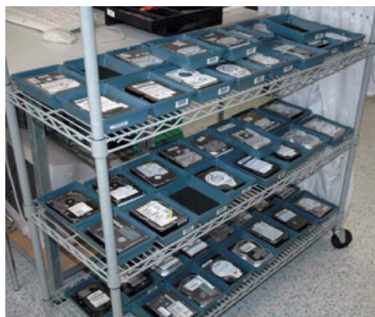
Рисунок 11. Коллекция винчестеров-доноров, используемая при пересадке контроллеров
