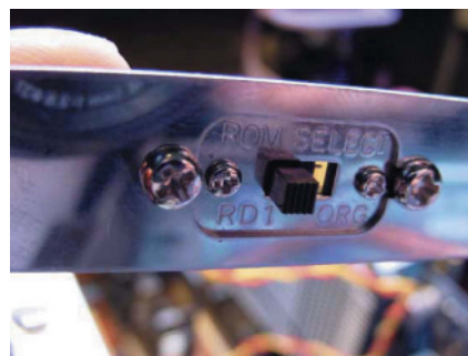
Рисунок 6. Переключатель, отвечающий за выбор между оригинальным (ORG) и экспериментальным (RD1) BIOS
