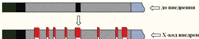
Рисунок 7. Внедрение X-кода в регулярные цепочки
