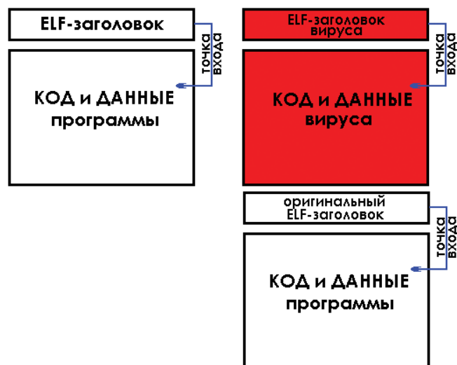
Рисунок 1. Типовая схема заражения исполняемого файла путем его поглощения
