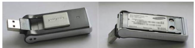
Рисунок 8. USB WiMAX-модем Samsung SWC-U200
