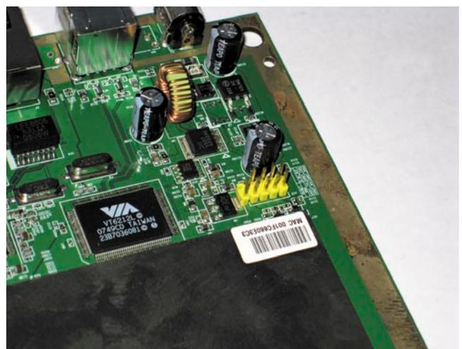
Рисунок 14. Подключение COM-порта: слева – нераспаянная площадка для подключения контактов; справа – контакты для подключения разъёма COM-порта
