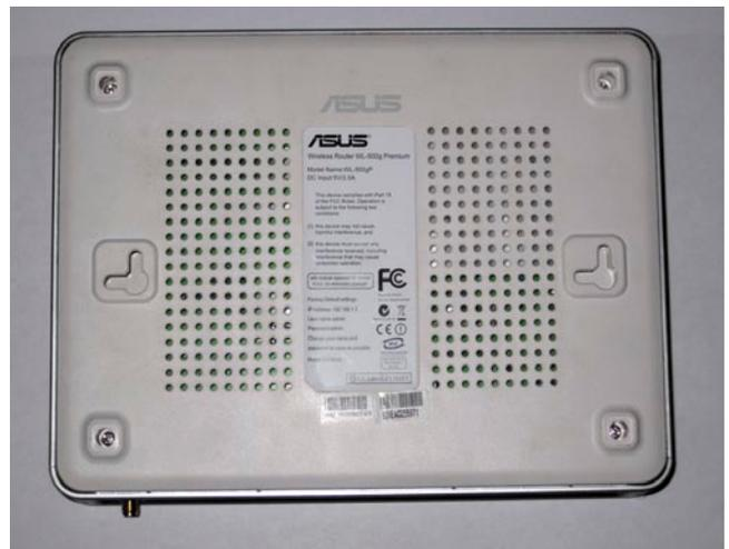
Рисунок 2. Вид маршрутизатора снизу. Отклеиваем ножки для разбора
