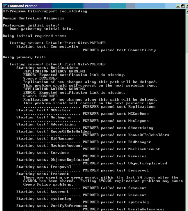
Рисунок 5. Результат успешного выполнения команды dcdiag на pserver
