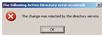
Рисунок 5. Ошибка при использовании дополнительного класса с обязательными атрибутами
