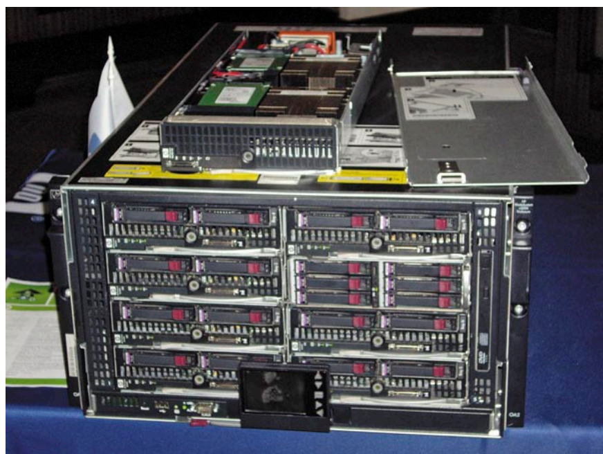
«Главные герои» конференции: серверная полка HP, укомплектованная различным оборудованием, в т.ч. HP Proliant BL460c и лежащий сверху HP Proliant BL495c G5
