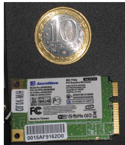
Рисунок 6. PCI Express MiniCard AzureWave AW-GE780 (AR5005B3)
