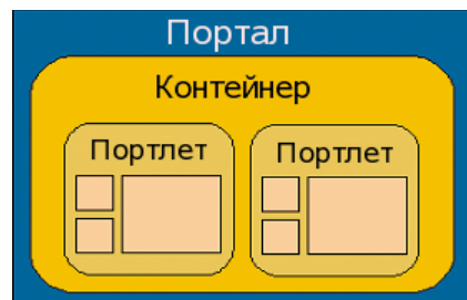
Рисунок 1. Структурная схема портала, созданного из портлетов
