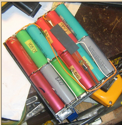
Батарея, перепакованная из б/у элементов
