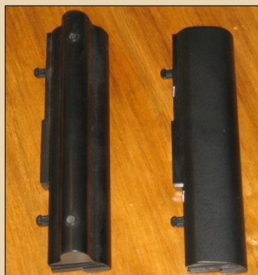
Справа стандартная батарея, слева – усиленная
