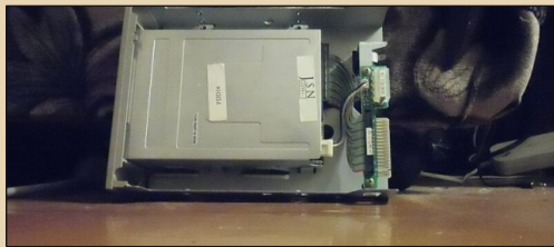
Рис. 12 Дисковод для трехдюймовых дискет для отсека 5,25” (вид сверху)
