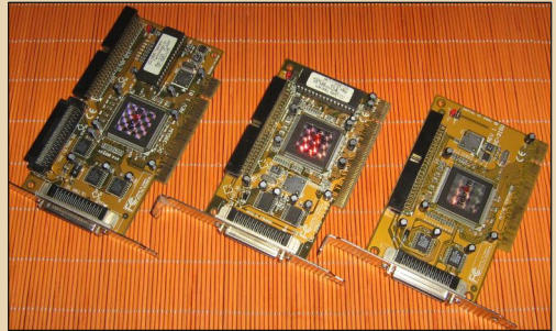
Рис. 14. «Линейка» SCSI-контроллеров фирмы Tekram для шины PCI. Справа налево: DC-315U (без BIOS, Narrow, 20 МБ/с), DC-395U (с BIOS, Narrow, 20 МБ/с), DC-395UW (с BIOS, Narrow+Wide, 40 МБ/с)
