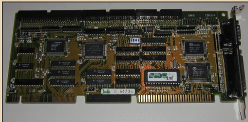
Рис. 13. Достаточно редкий SCSI-контроллер Iwill SIDE для шины VLB (для 486-х). На той же плате – контроллеры FDD, IDE, GAME, COM, LPT!
