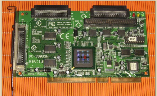
Рис. 15. «Современный» SCSI-контроллер фирмы Tekram DC-390U3W для шин PCI 32/64/66. Два канала SCSI Wide+Narrow, LVD+S/E, скорость до 160 МБ/с
