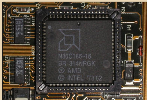
Рис. 18. Микропроцессор RAID-контроллера – аналог i80186
