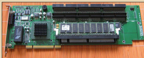
Рис. 19. IDE RAID-контроллер PROMISE SuperTRAK SX6000 для шины PCI
