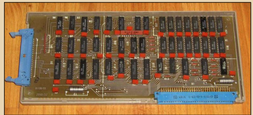
Плата расширения «Поиска» – контроллер принтера, совмещённый с ОЗУ (со снятой крышкой)
