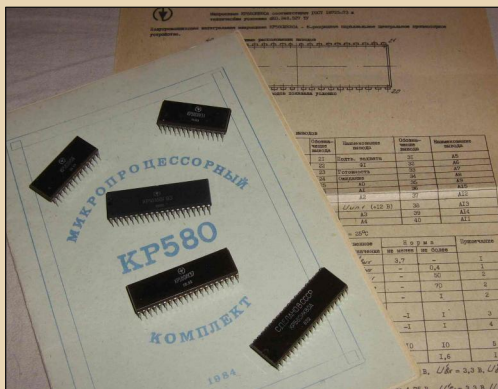
Микропроцессорный комплект 580-й серии вместе со справочной книжкой
