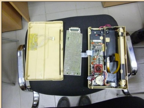
Рис. 3 Разобранный принтер с установленным новым шлейфом – выглядит не аутентично, но питание подается
