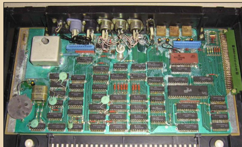
Внутренний вид «Спектрума» заводской сборки – «Дельта-С». С платы выкушены «КМ-ки»
