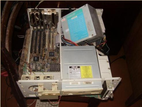
Рис. 7 Мой основной старый компьютер Intel 486DX2 80 МГц, 16 МБ ОЗУ, материнская плата содержит VLB и PCI одновременно. Сам компьютер в процессе – возможно, и материнская плата поменяется на Socket 5/Pentium 75 МГц
