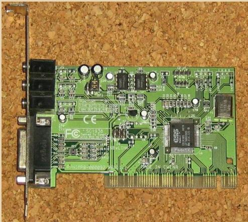
Другая PCI-ная звуковая карта – пример того, что на чипе S3 (09C3FB) может быть сделана не только графическая, но и звуковая плата. S3 Sonic Vibes обеспечивает совместимость с SB16 для DOS-овских игр. При этом он связан с компьютером через быструю шину PCI, что поз-
