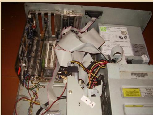
Рис. 3 Он же внутри – видеокарта, звук поменялись, сетевой карточкой сперва не было, жесткий другой, но материнская плата и процессор те же самые
