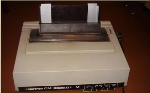
Рис. 1 Robotron CM6329.01 во всей красе – попался именно с интерфейсом V.24
