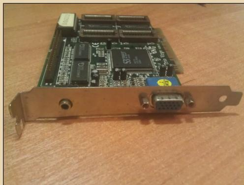
Рядом с разъемом VGA расположен 3,5 мм джек, предназначенный, вероятно, для подключения стереоочков (привет, NVidia 3D Vision! :-). На этом основные отличия от Trio заканчиваются, и начинаются проблемы.
