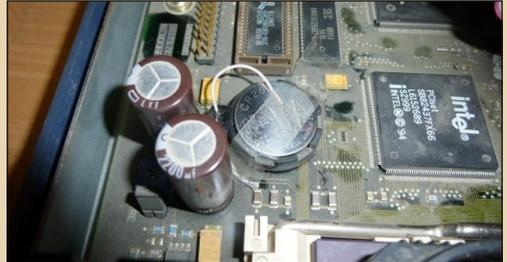
Рис. 4 Разъем для батарейки после «ремонта» – вроде сейчас настройки CMOS сохраняются!
