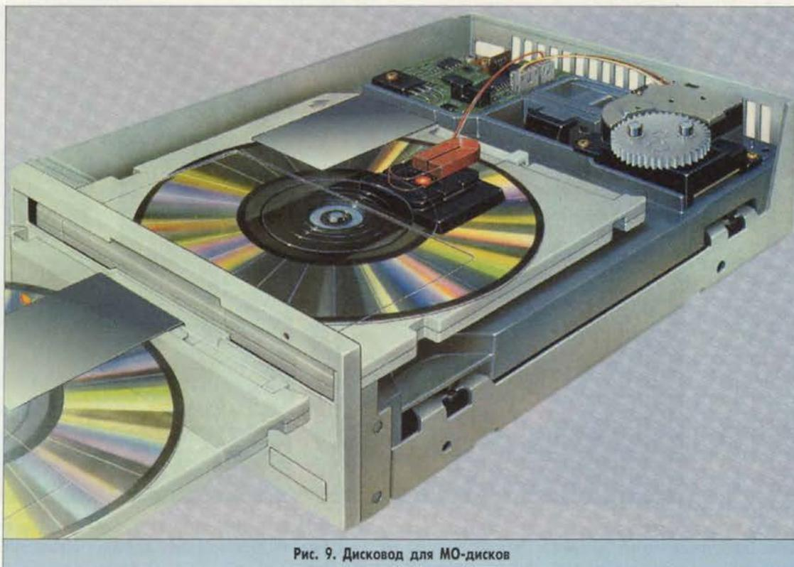
писывающего" луча). Отраженный свет попадает на светочувствительный элемент, который определяет направление поляризации. В зависимости от этого направления светочувствительный элемент посылает двоичную единицу или двоичный ноль контроллеру MO-дискового.
