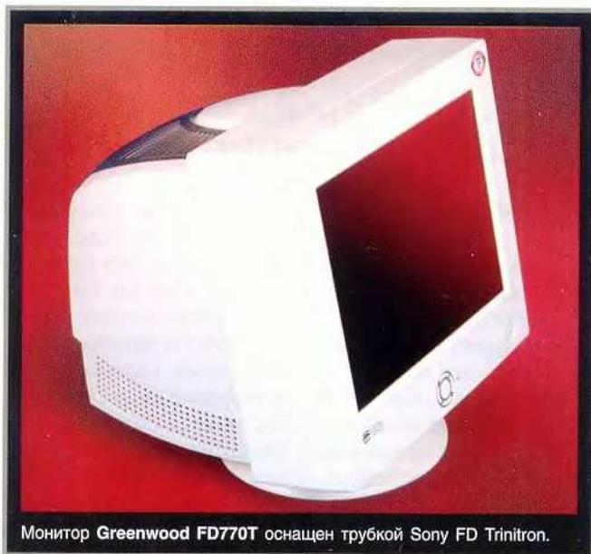
Монитор Greenwood FD770T оснащен трубкой Sony FD Trinitron.
