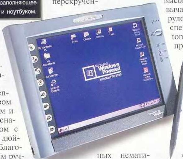
ных нематрических элементах) с пассивной матрицей, задней подсветкой и разрешением 640×480 пиксел, способный воспроизвести 256 цветов, хорошо работал в помещении, но при солнечном освещении изображение было блеклым. Вариант устройства, предназначенный главным образом для использования вне помещений, снабжен отражательным экраном и стоит 1650 долл. Сенсор-
