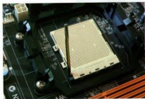
■ Впервые процессорный разъем интегрирует, большинство кулеров для Socket 939 имеют установку на четыре крепежных отверстия, соответствующих перфорации на разъеме сокета. В таком случае стал более надежным — разъем фиксируется на месте четырем винтами (заметно друг), и новые кулеры будут крепиться на четыре угловых отверстия.
