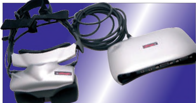
■ Вот он — шлем виртуальной реальности eMagin Z800 3D Visor. Разрешение: 800х600 для каждого глаза (2,8 Мпикс.); визуальный эквивалент: 105 дюймовый экран на расстоянии 3,6 м; цвет: 24-бит 16,7 млн. цветов; яркость: 50 кд/кв. м; контрастность: 200:1; трекер: 360 градусов по горизонтали и 60 по вертикали; цена: $1349.
