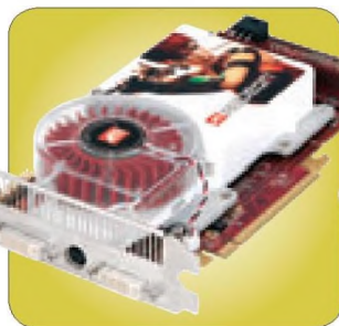
слева Кулер Radeon X1800 XT похож на виденный нами у Radeon X850 XT, однако радиатор внутри более массивный, а вентилятор постоянно работает на минимальных оборотах.
