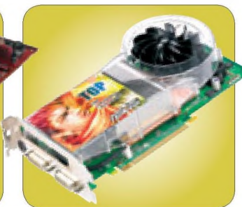
слева Кулер Radeon X1800 XT похож на виденный нами у Radeon X850 XT, однако радиатор внутри более массивный, а вентилятор постоянно работает на минимальных оборотах.
