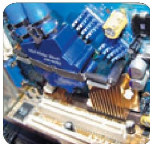
вверху Процессорный водоблок. внизу Теплообменник для видеокарты.
