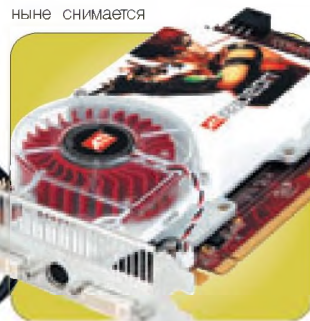
слева Вместо SLI-моста видеокарты АТІ соединяются вот таким Crossfire-кабелем. справа Представитель нового поколения «канадцев» — на ближайших подступах.
