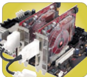
слева Двухголовая платформа ATi Crossfire. Все в сборе! справа Два графических порта PCI-Express 16x. Скоро и на платах с чипсетом ATi Radeon 200P Crossfire Edition!
