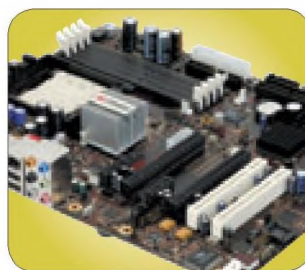
слева Двухголовая платформа ATi Crossfire. Все в сборе! справа Два графических порта PCI-Express 16x. Скоро и на платах с чипсетом ATi Radeon 200P Crossfire Edition!
