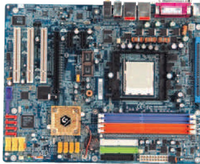
вверху Gigabyte GA-K8NXP — типичная плата на чипсете nForce4.
