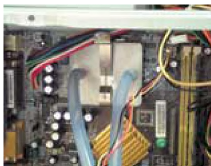
Пока наш GeForce FX 5800 Ultra будет охлаждаться таким образом, а там посмотрим...
