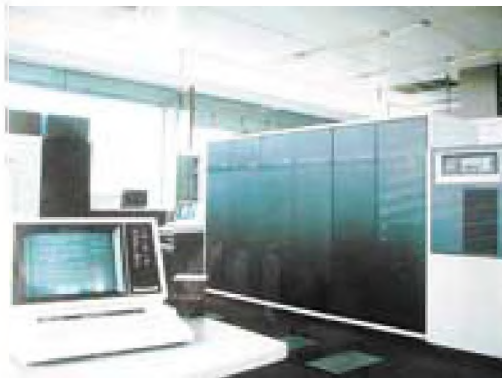
► Следующий из мэйнфрейм-заповедников. В комод слева находится процессор, в шкафу справа — оперативная память. Все 36 бит. Все вместе — Zork I.
