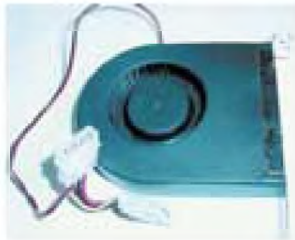
Самое нехитрое устройство для охлаждения видеокарты — «вытяжка», она же — в прайслистах — blower.
