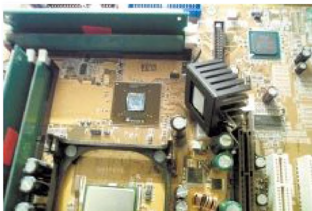
Чипсеты. Просто чипсеты. Это именно их северные мосты выглядят ничуть не хуже процессоров: тот же FCPGA-корпус с огромным числом выходов и частоты, которым позавидовали бы ЦП совсем недалекого прошлого...
