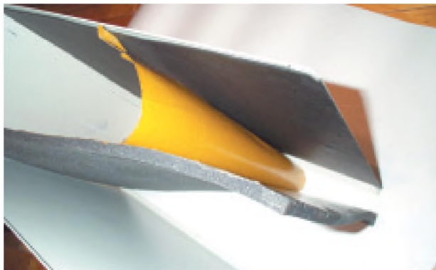
Самоклеящаяся двухслойная изоляция в действии (на крышке корпуса).
