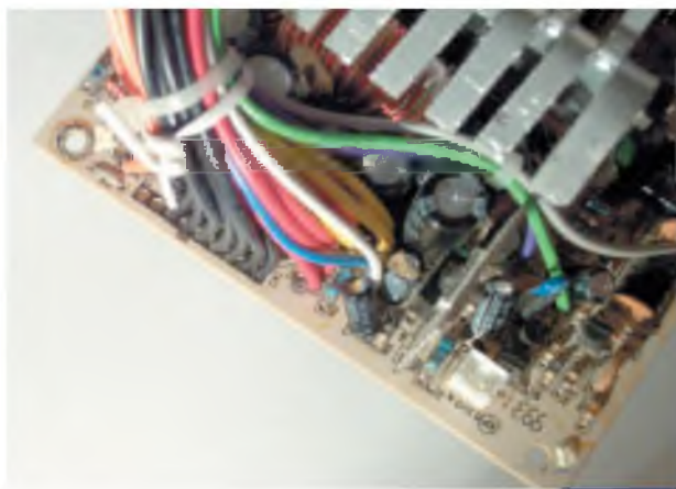
В блоке питания вентилятор можно обеспечить самым разнообразным питанием (10, 7, 5 вольт).
