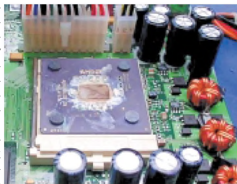
Перегревшийся процессор не только погиб сам, но и сжег материнскую плату с блоком питания. Замена убитых компонентов обошлась в $200.
