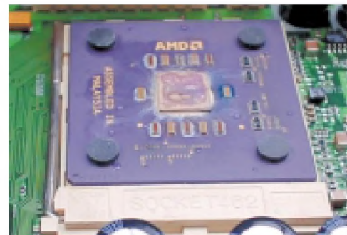
После расставания с кулером процессор Athlon MP моментально нагрелся до 300 градусов Цельсия и отошел в мир иной.
