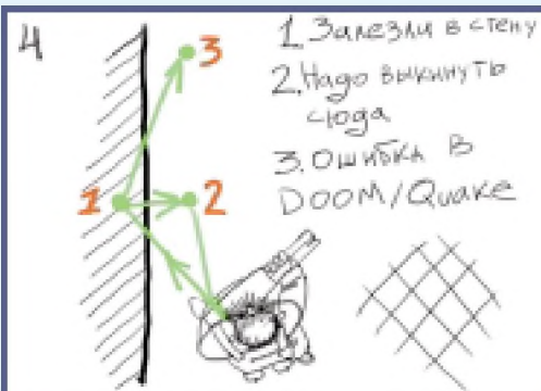
Рис.4. Алгоритм "вытаскивания" модели из стены или пола даже в популярных игрушках дает сбой, перемещая ее не в точку 2, как хотелось бы, а в точку 3, тем самым увеличивая скорость модели, движущейся вдоль стены.
