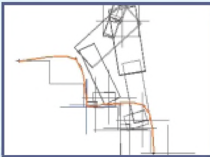
Рис.2. Обратите внимание: ногам задана только траектория, по которой они движутся, а вся остальная фигура изменяется автоматически.
