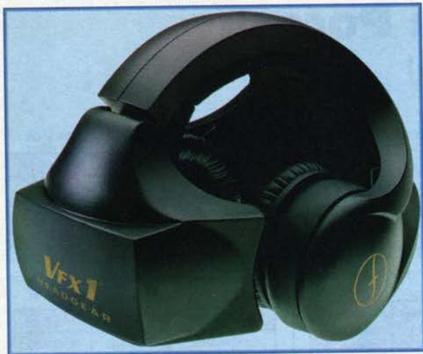
подобных благодаря целому ряду особенностей. Одна из них — наличие специально разработанной спецификации Access Bus — канала, при помощи которого можно подключить к компьютеру не только шлем, но и массу других атрибутов системы VR, таких как перчатки, датчики изгиба и пр. Скорость передачи данных в канале — 100 Кбит/с. В комплекте с шлемом поставляется система отслеживания перемещения с тремя степенями свободы.
